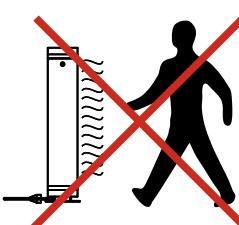
После включения светильника УФ-С STERILON FLOW **нельзя** оставаться в помещении, в котором он работает. Во время его включения/выключения **необходимо** использовать защитные очки и иметь на себе одежду с длинными рукавами и защитными перчатками.
