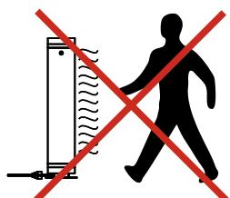
Po uruchomieniu lampy UV-C STERILON FLOW w trybie dezynfekcji bezpośredniej, **nie można przebywać w pomieszczeniu**, w którym działa lampa.
