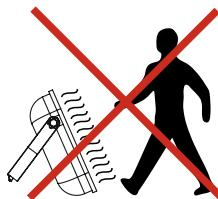
**PL** Po uruchomieniu lampy UV-C STERILON, **nie można przebywać w pomieszczeniu, w którym działa lampa**. Podczas jej włączania/wyłączania **należy używać** okularów ochronnych oraz mieć na sobie odzież z długim rękawem i rękawice ochronne. **Unikać kontaktu ze źródłem światła. Światło UV-C jest szkodliwe dla oczu i skóry.**
